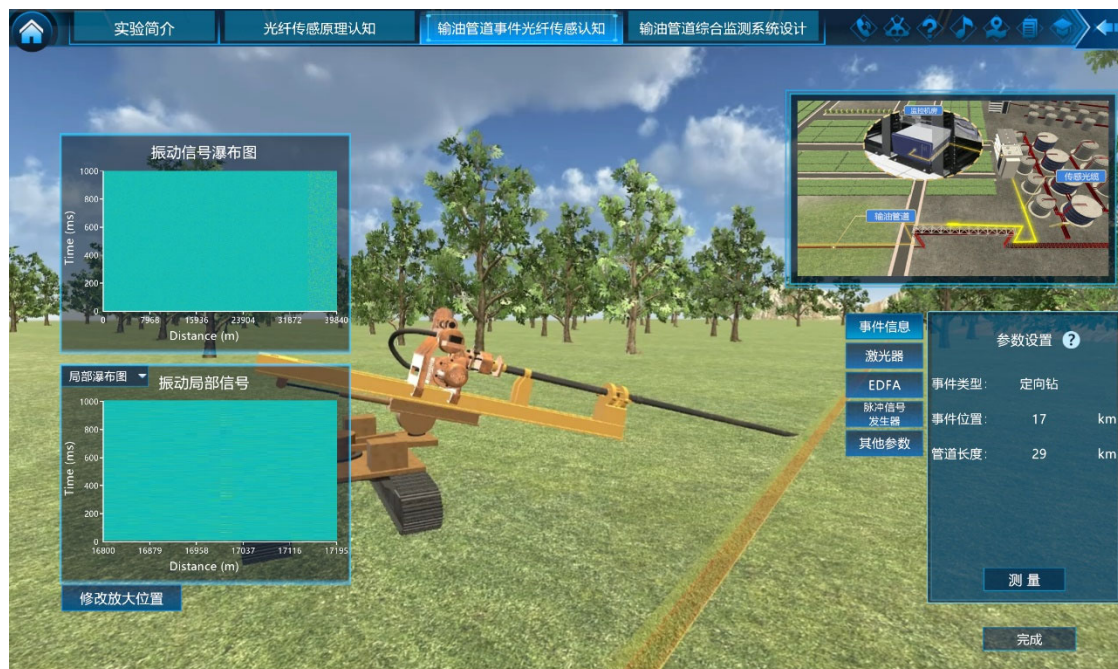
图 43 \Phi -OTDR 对输油管道事件测量的局部放大
