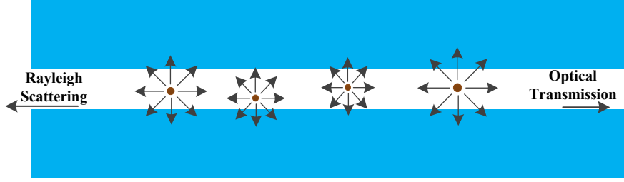
图 4.3 光纤中的散射点
